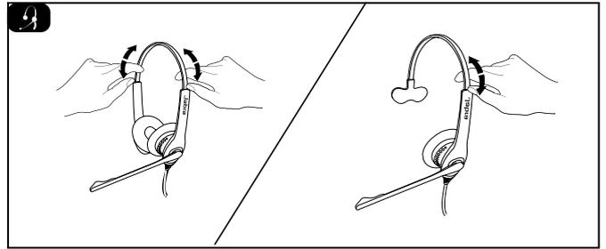
Verstellbarer Überkopfbügel für Duo- oder Mono-Variante
