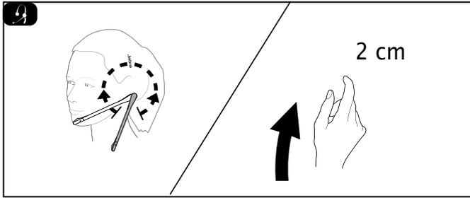
Das Jabra BIZ 2300 und 2400 II verfügt über einen um 360° frei drehbaren Mikrofonarm. Das Jabra BIZ 1500 hat einen um 270° frei drehbaren, ebenfalls bruchsicheren Mikrofonarm und lässt sich beliebig anpassen.
